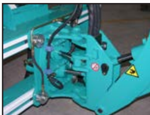
Cilindri della rotazione con optional del bloccaggio idraulico della traslazione. Rotation cylinders and hydraulic block of the frame translation.
