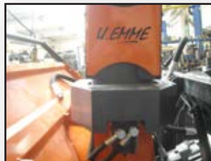
Motore idraulico per orientabilità camino. Hydraulic motor for chute rotation.
