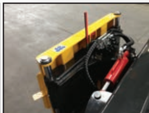
Sistema di autolivellamento verticale 300 mm. 300 mm. vertical self-levelling system.
