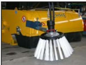
Spazzola pulizia laterale Ø 580 mm con motore idraulico indipendente
